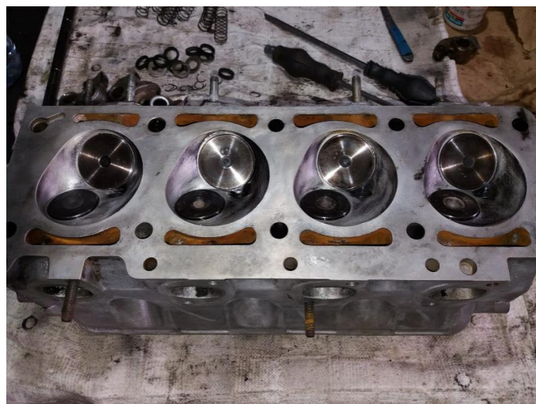
Figura 23- Cabeça faceada e Válvulas instaladas
