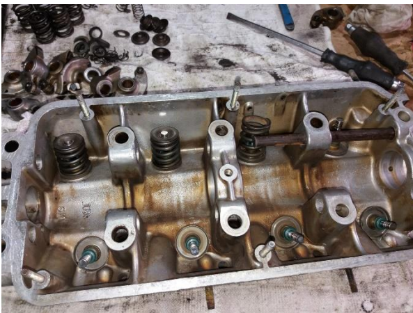
Figura 23- Remoção das Válvulas
