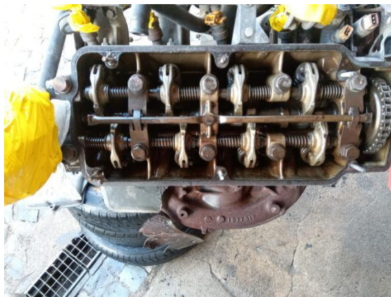
Figura 14- Remoção da Tampa de Válvulas
