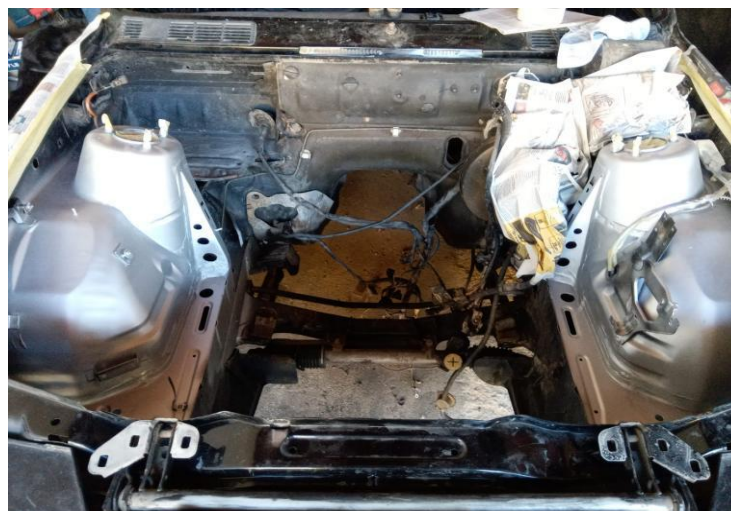
Figura 21- Cofre do Motor Galvanizado
