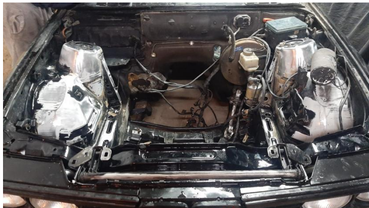
Figura 20- Cofre do Motor Lixado
