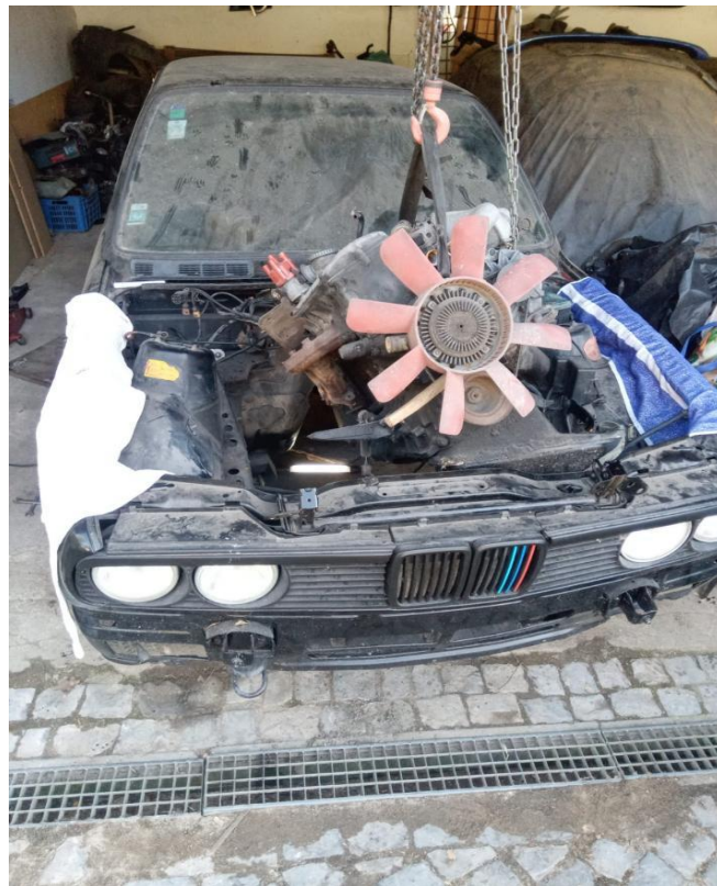
Figura 12- Remoção do motor e caixa
